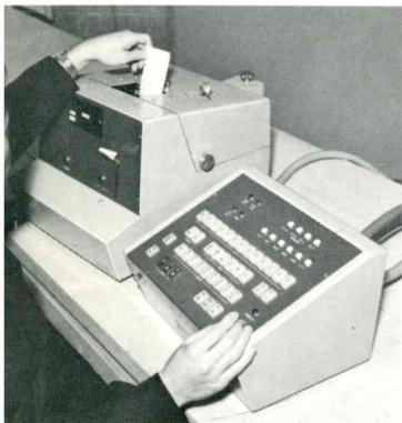
3. Electronic Reservation System (Tickets are automatically printed.) Appareillage électronique de réservation des billets. (Les billets sont imprimés automatiquement.)
