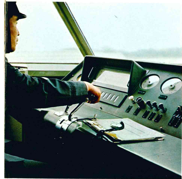
25. Motorman's cab Dispositif de l'ATC dans la cabine de conduite
