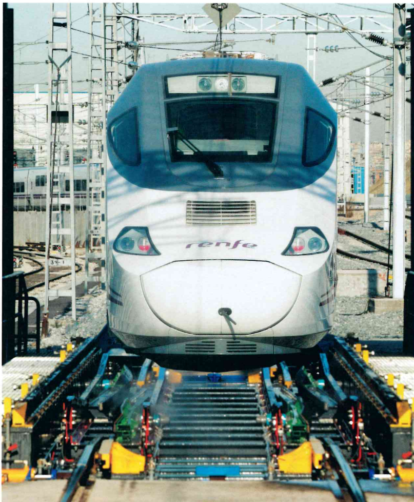
Los cambiadores de ancho Talgo entraron en servicio comercial en 1969, y desde entonces han pasado por ellos cerca de 100.000 trenes sin ninguna incidencia significativa. Los nuevos cambiadores (como el de Santa Catalina en la foto) permiten pasar a trenes completos (es el caso del 130) y por ello tienen catenaria. El tren no se detiene, reduce la velocidad a unos 20 km/h y los viajeros sólo notan como si el tren pasara por un puente metálico. (Foto: JM Luna, Vía Libre).
