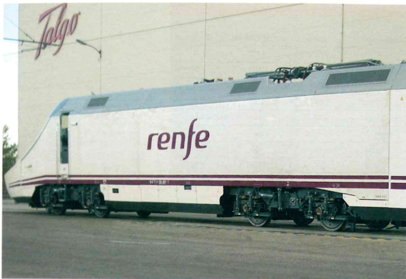
El tren de la serie 130, desarrollado por Talgo, permite al tren completo pasar por el cambiador. Estos trenes, que pueden alcanzar los 250 km/h, han comenzado sus pruebas en 2006, y con el 120 de CAF están llamados a llevar el peso de los principales servicios de viajeros en los próximos años en los que coexistirán tramos parciales de las nuevas líneas de alta velocidad con la red convencional. (Foto: Gonzalo Rubio).
