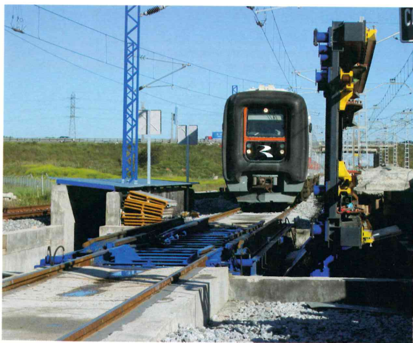
El bogie Brava de cambio de ancho de CAF nació en 2000 con su aplicación a un tren diesel de la serie 594, como el que aparece en la foto en el cambiador de Zaragoza a punto de pasar del ancho internacional al ancho ibérico. (Foto: Sergio López Lara).
