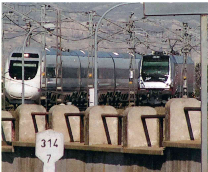
Tanto Talgo como CAF han desarrollado sistemas de cambio de ancho automáticos para trenes de viajeros. En la foto (Grisén, 2006) aparece el tren de CAF (serie 120) y la locomotora experimental de Talgo-Team numerada L9202. (Foto: Sergio López Lara).
